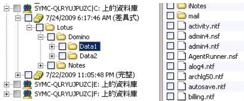
圖 F-1 Backup Exec 選取項目檢視中出現的 Domino 伺服器檔案類型
